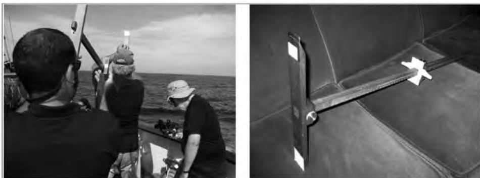
Fig. 8. Observando com a balestilha de costas ao Sol, a bordo do *Creoula*. À direita, a réplica da balestilha preparada para observar de costas. Note-se em ambas as imagens a posição da soalha, fixada no extremo anterior do virote e a chapa com ranhura na parte superior da soalha, que produzirá uma sombra que corresponde ao centro do Sol, tal como o astrolábio. Note-se também a soalha móvel, ou *martinete*.
