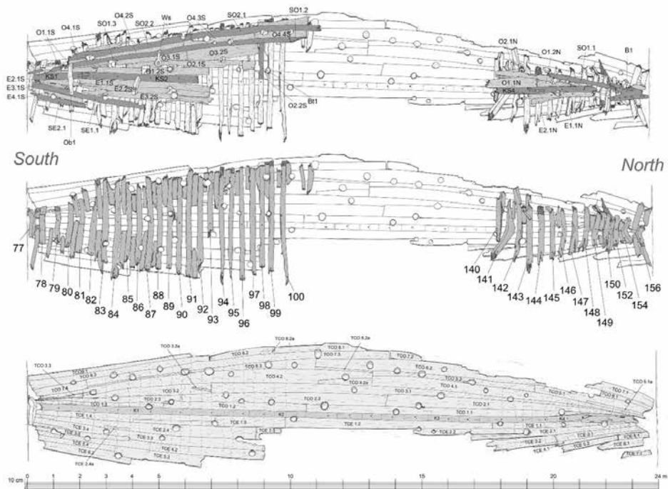
Figura 3 – Planta do navio do Cais do Sodré.
