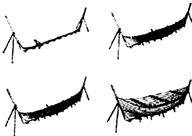
Fig. 69 – Construção mista, com assentamento inicial da quilha, rodas e tabuado do costado, e só depois as cavernas, como está demonstrado na Holanda.
