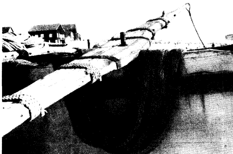
Fig. 58 – Fotografia de Johnstone de um remo de um pequeno Barco do Mar, para ilustrar a sua semelhança com os remos dos Curragh e Coracle , caraterística que não se encontra em qualquer outro barco de todo o Mundo.
