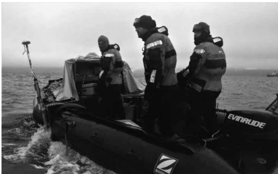
Figura 11 – Levantamento com sondador de feixe simples instalado numa embarcação tipo bote
