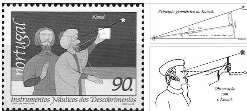
Fig. O kamal e o seu princípio geométrico.
