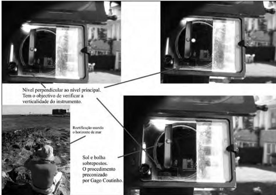
Fig. 12. Observações em terra com o sextante Plath, System Gago Coutinho. Exemplar existente na Escola Naval. Rectificação usando o horizonte de mar
