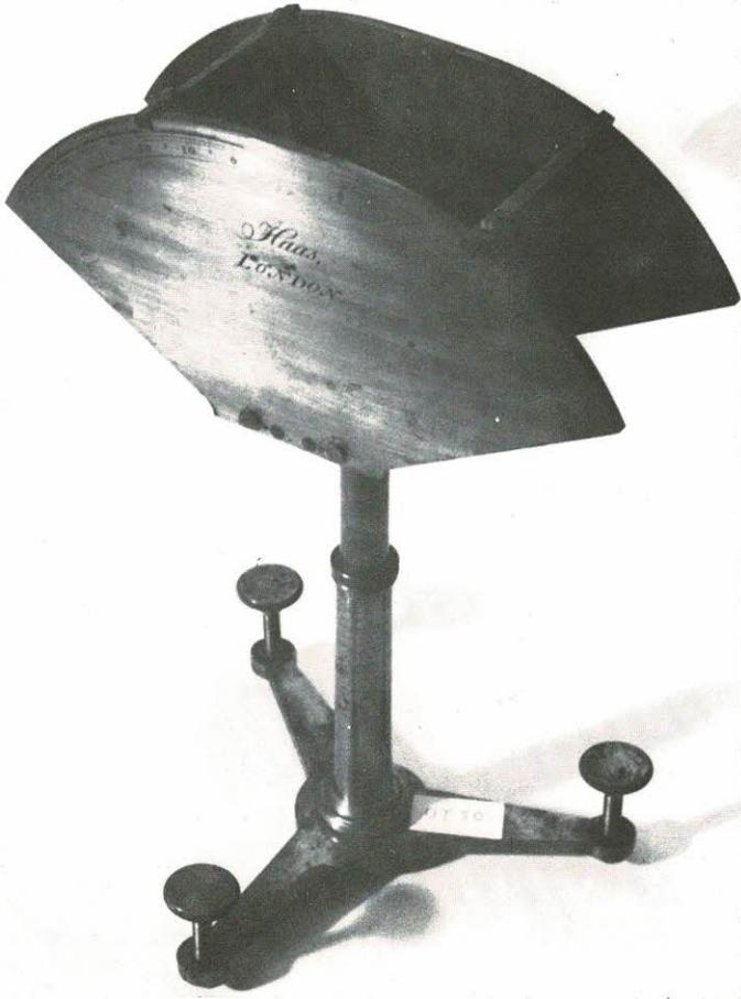
FIG. 15 — Prisma de faces móveis para a determinação dos índices de refração dos líquidos, Jacob B. Haas
