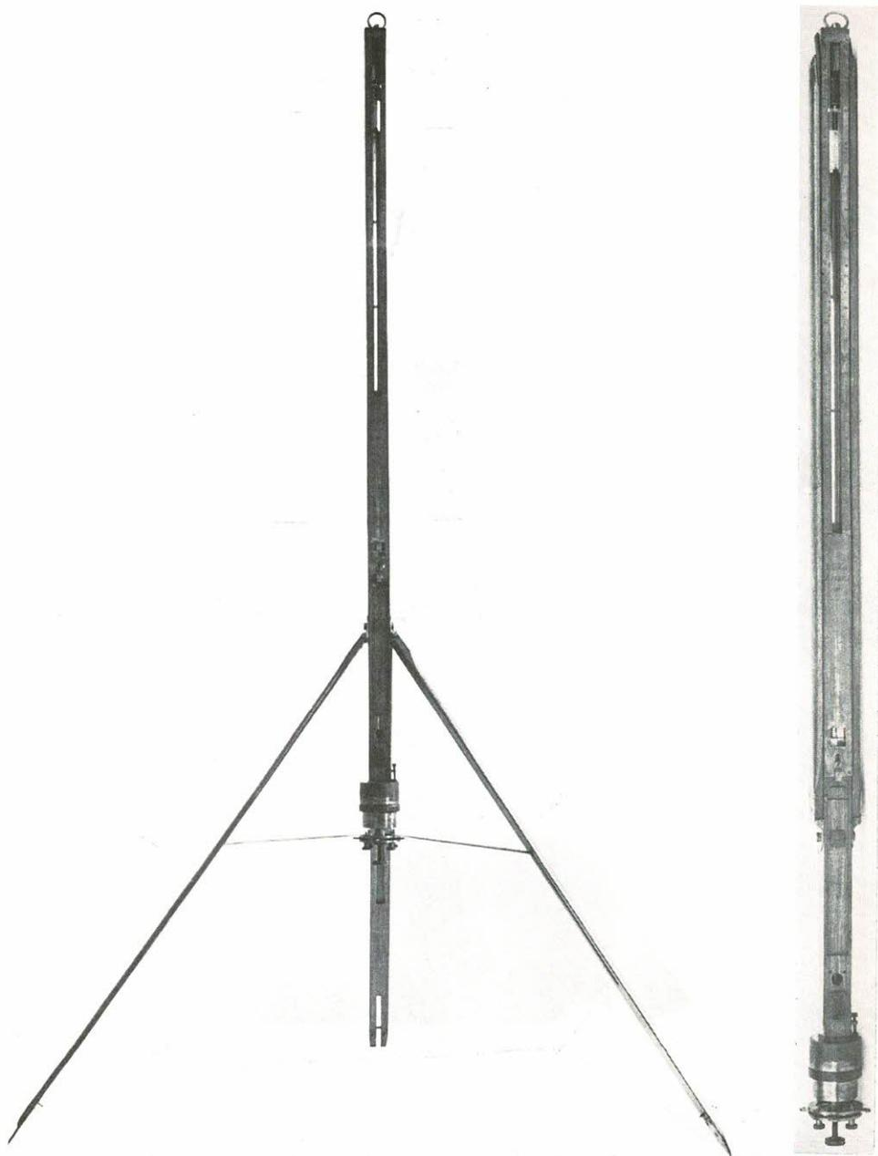
FIG. 34 — Barómetro de montanha, em utilização e fechado, Jacob B. Haas
