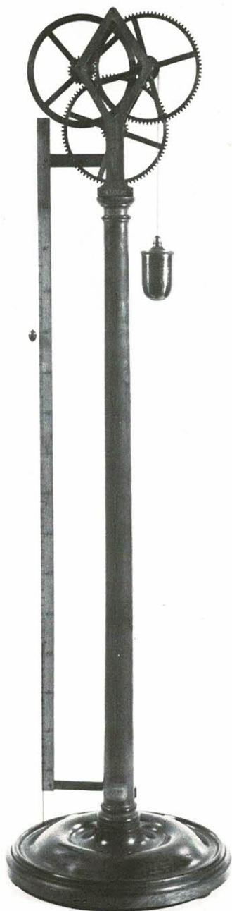
FIG. 24 — Sistema de rodas dentadas para o estudo de equilíbrio, Jacob B. Haas
