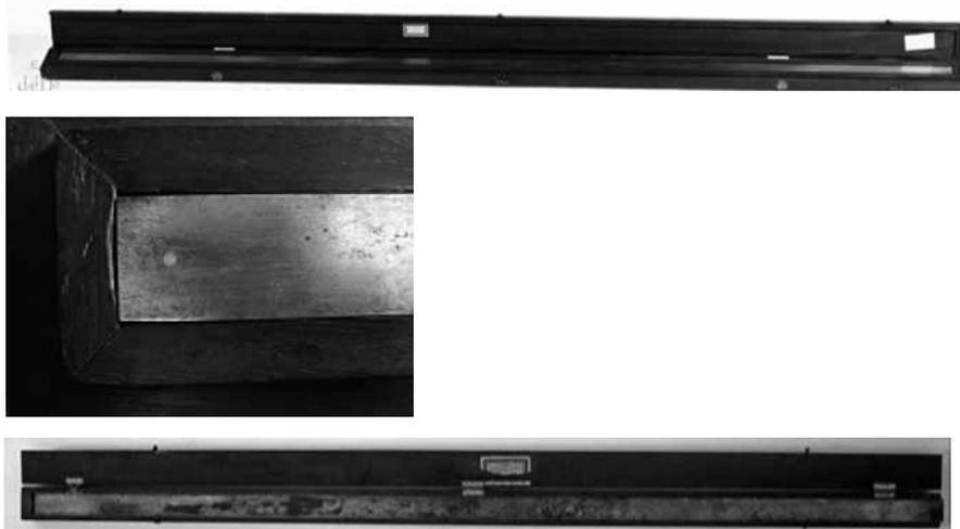
Figura 14 – A “Braça de Ciera” (topo), ilustrando o pormenor da marca de ouro incrustada de uma das extremidades (meio). A imagem do fundo ilustra a “Meia-braça de Ciera”. (Fonte: Imagem no topo da figura cedida pela Direcção Geral do Território. As imagens do meio e do fundo da figura foram obtidas pelo autor, por cortesia da Direcção Geral do Território.)
