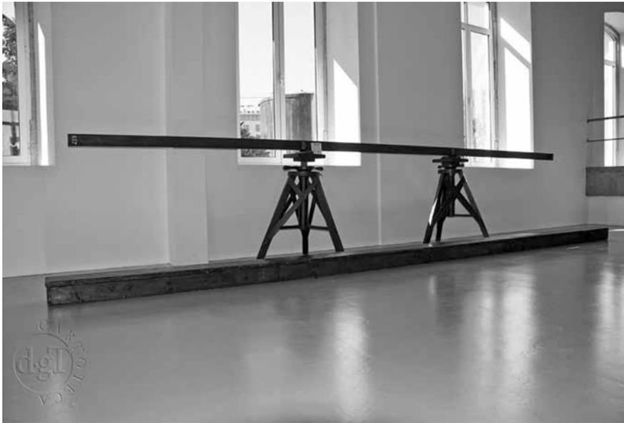
Figura 12 – Exemplar de uma das régua de madeira usadas por Francisco Ciera para medir as bases da triangulação geodésica. Numa das extremidades (à esquerda) é claramente visível uma das peças metálicas para ajuste e controlo do comprimento. (Fonte: Imagem cedida pela Direcção Geral do Território.)
