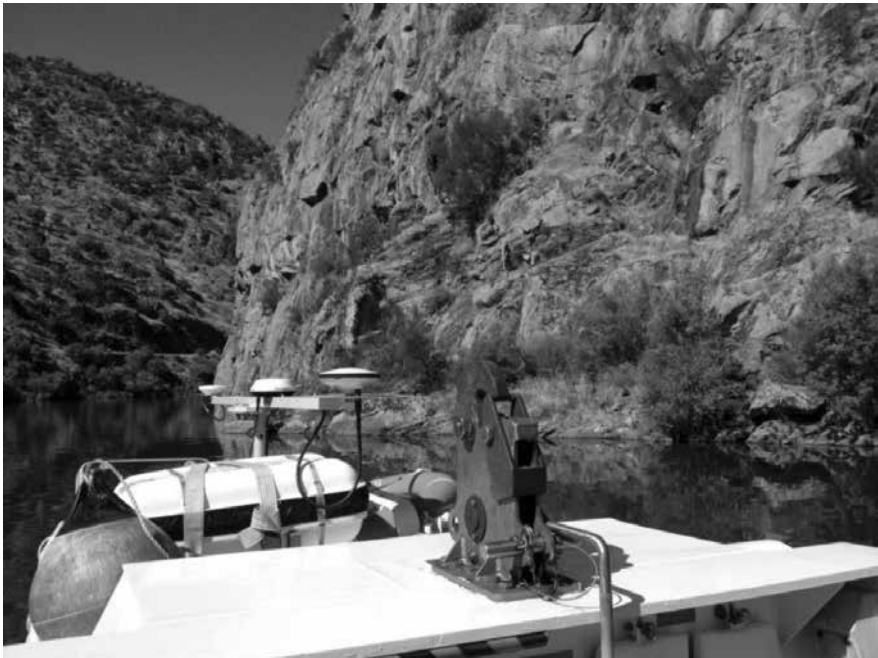
Sondagem com a lancha hidrográfica na albufeira da Valeira.
